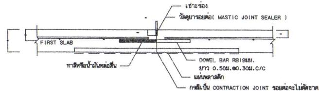
ขยายรอยต่อ CONSTRUCTION JOINT และ CONTRACTION JOINT
