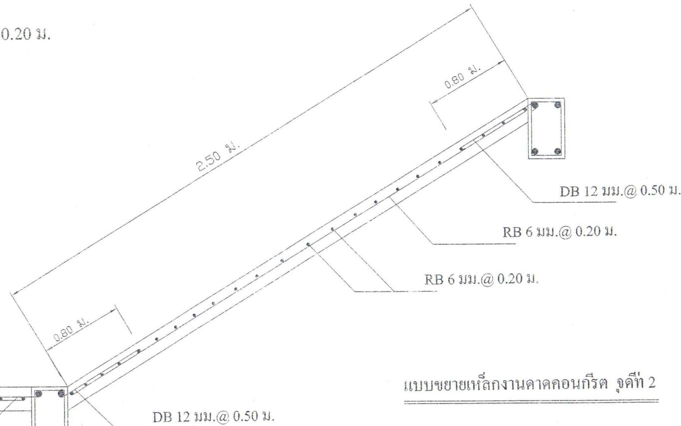
แบบขยายเหล็กงานคาดคอนกรีต จุดที่ 2
